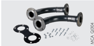
Winkelstücksatz, 90°, DN 65, für Kaskadenanlagen von 304 bis 455 kW - Kolli HC209 Winkelstücksatz, 90°, DN 100, für Kaskadenanlagen von 460 bis 608 kW - Kolli HC210 Mit Dichtringen, Schrauben und Muttern. Erlaubt den Anschluss von einer hydraulischen Weiche an das Sammelrohr.
